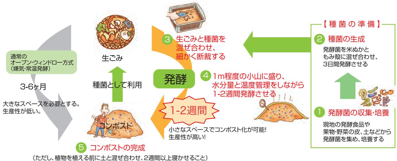
高倉式コンポスト手法では生ごみを1~2週間で発酵させ、コンポスト化します。これは通常のオープン・ウィンドロー方式(嫌気・常温発酵)で3ヶ月以上かかるのと比較し、大幅な短縮です。この短期間での発酵を可能にしているのが、現地材料から収集し培養した発酵菌の活用です。発酵菌(または種菌)を生ごみと混ぜ断裁し、それを小山に積んでおくと数時間後には温度が70~80度まで上昇し、生ごみの発酵が進みます。このため1~2週間で生ごみの有機分の多くが分解でき、短期間でコンポスト化することができます(ただし、有機分の分解は完全には終わっていないため、植栽に利用する前に、2週間以上土と混ぜ合わせておく必要があります)。このようにして、小さなスペースで多くの生ごみを処理することができるのです。
